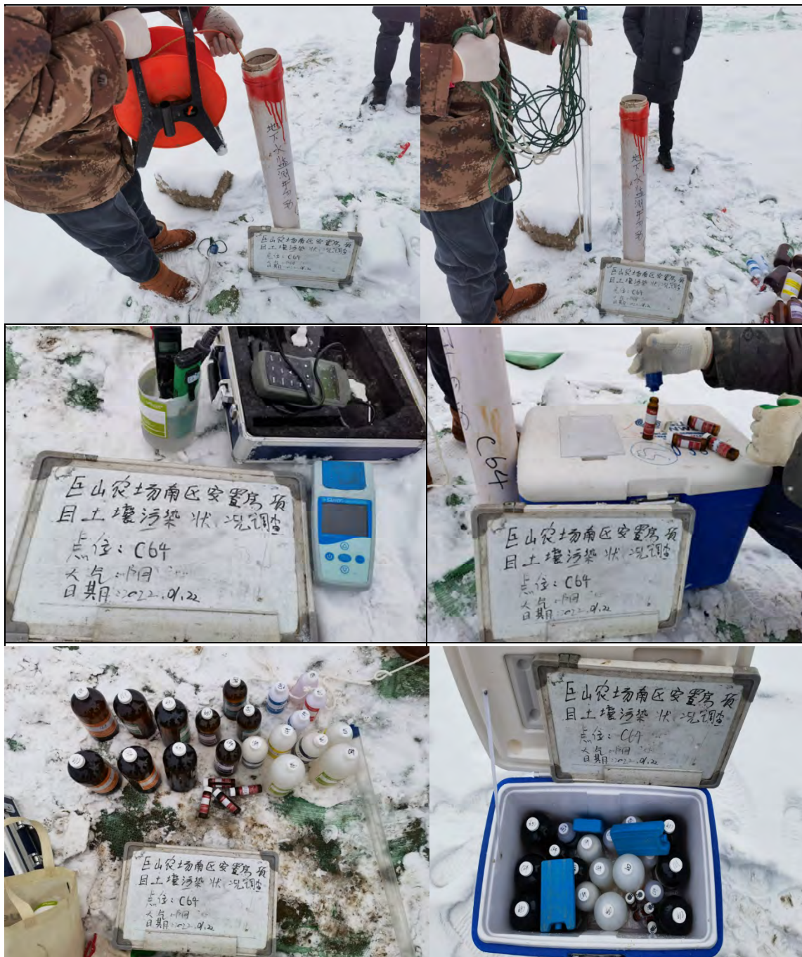
图 4.4-5 地下水样品的采集
